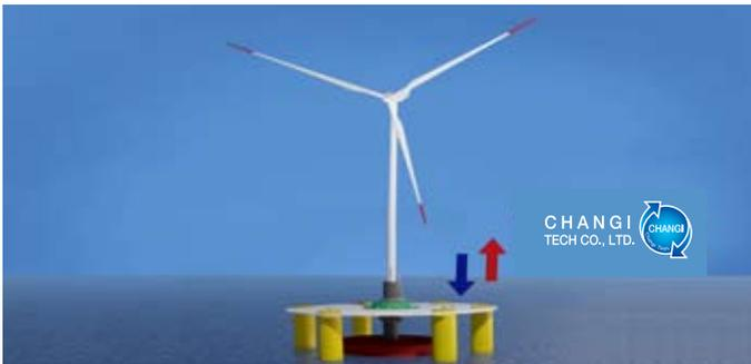
[그림 1] 창이테크(주)의 타워-부유체 조인트 분리 하이브리드형 부유식 해상풍력 발전기 모델
